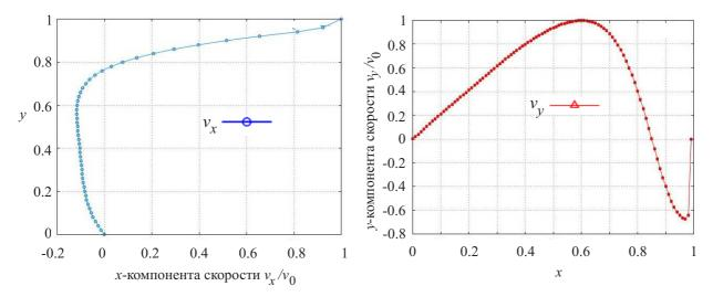
Рис. 8. Графики компонент x (слева) и y (справа) вектора скорости для  $\mathrm{Re}=100$
