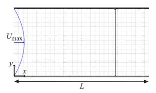
Рис. 3. Модель течения в задаче Пуазейля
