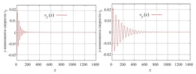
Рис. 14. График зависимости y-компоненты скорости от x-координаты при  $\tau=1.0$  и T=50 (слева) и T=100 (справа)
