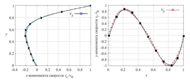
Рис. 6. Сравнение полученных аналитически графиков компонент x (слева) и y (справа) вектора скорости (синяя и красная ломаные) с результатами [23] (черная ломаная) для  $\mathrm{Re}=1$
