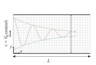
Рис. 10. Модель течения жидкости во второй задаче Стокса
