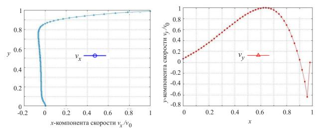
Рис. 9. Графики компонент x (слева) и y (справа) вектора скорости для  $\mathrm{Re}=300$
