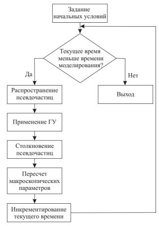
Рис. 2. Блок-схема реализованного программного комплекса
