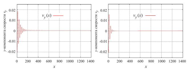
Рис. 15. График зависимости y-компоненты скорости от x-координаты при  $T=50,~\tau=1.0$  (слева),  $\tau=0.8$  (справа)
