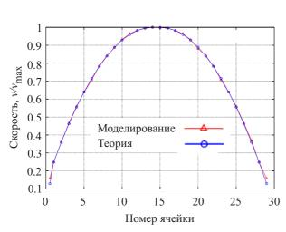
Рис. 4. График распределения x-компоненты скорости вдоль поперечного сечения трубы для теоретического решения и решения, полученного при моделировании
