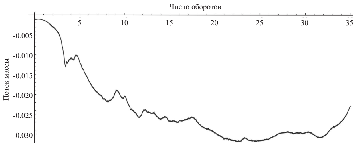
Рис. 7. Поток массы через внутренний радиус, в ед. начальной массы. Отрицательные значения отвечают оттоку вещества за пределы расчетной области
