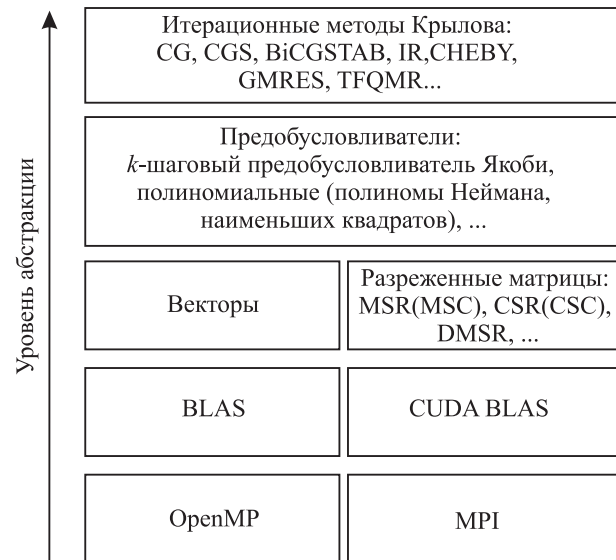
Рис. 1. Схема библиотеки gcu_sparse
