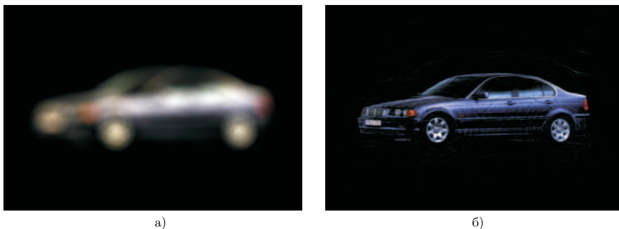
Рис. 6. Дефокусированное изображение. Модельная задача: а) дефокусированная фотография, б) восстановленная фотография. Разрешение — 1024 \times 768 , время расчета — 11 секунд
