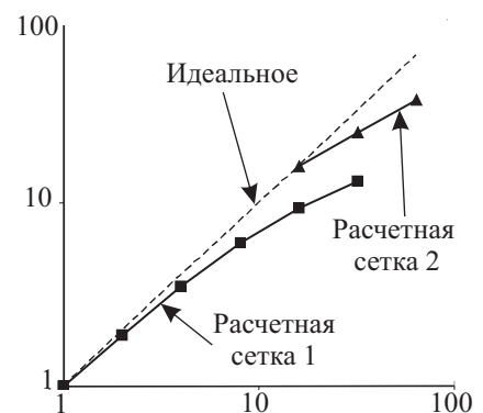
Рис. 10. Ускорение при решении задачи о подводной лодке для расчетных сеток 1 и 2
